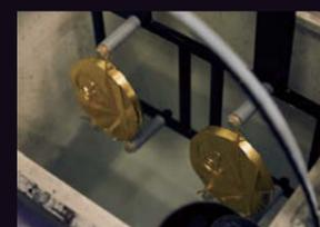
金メダルは、銀製のメダル表面に金メッキを施しています。表面に6g以上の金を付着させるのは至難の業。光沢が出る装飾用金メッキ液へ2時間以上も浸す必要があります。
